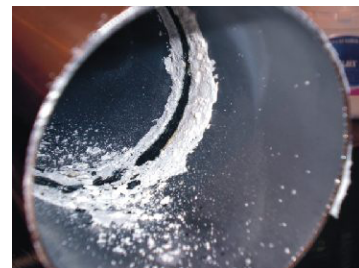
Después de soldar, antes de la limpieza
