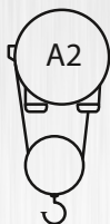
MOD. A2 2 VELOC. IZAJE SIN CARRO DE TRASLACION Y CON APOYO PARA CARRO BIRRIEL
